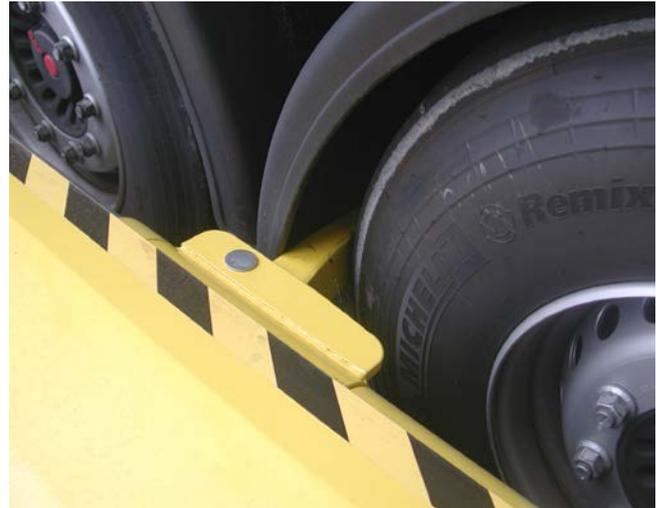
Abb. 4 und 5: Stop Truck®-System mit Einfahrhilfe (links) und Blockierarm
